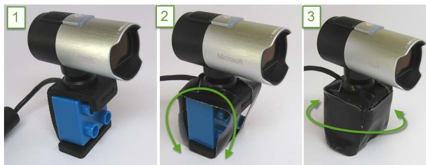
Рисунок А.1: Стабилизатор вебкамеры: (1) Вставьте пластиковый распирающий блок, (2) обмотайте двумя узкими полосками монтажного скотча, и (3) обмотайте широкой полоской одностороннего скотча.
