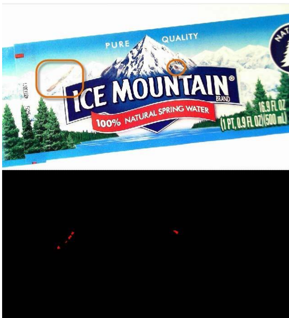
Рисунок 13.2: Этикетка с двумя дефектами в виде карандашных пометок (обведены) и соответствующее двоичное изображение, сформированное скриптом.
