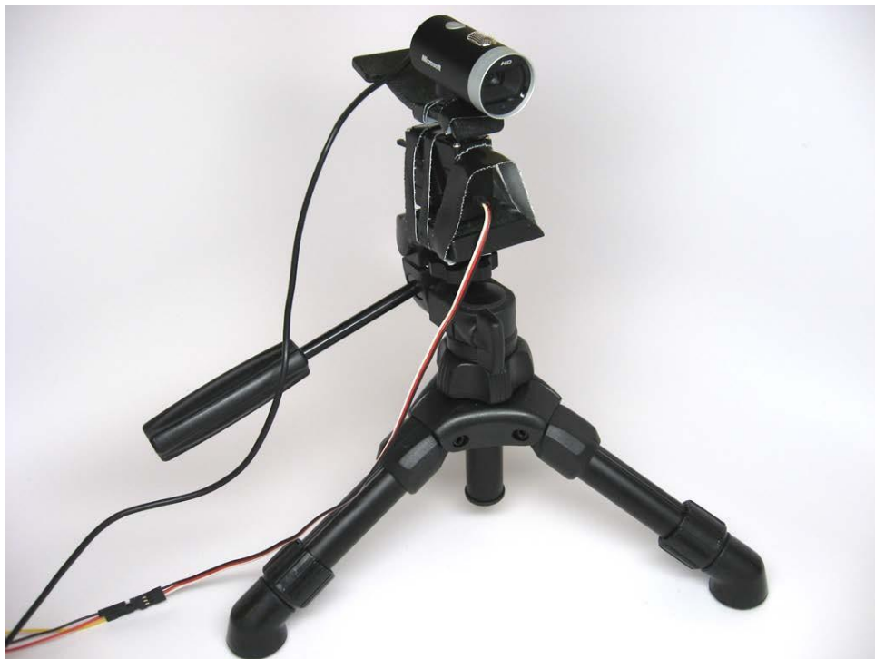
Рисунок 16.3: Вебкамера, установленная на серводвигателе, который, в свою очередь, установлен на небольшом штативе. Используйте полоски скотча для крепления камеры и серводвигателя к штативу.
